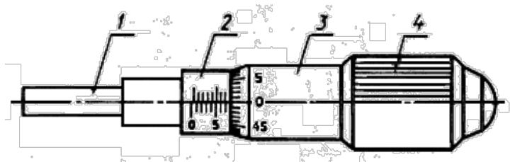
1 - микрометрический винт; 2 - стебель; 3 - барабан;
