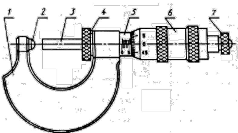
1 - скоба; 2 - пятка; 3 - микрометрический винт; 4 - стопор;
