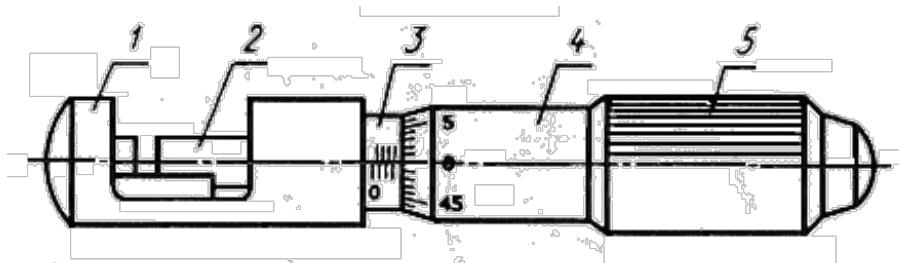
1 - корпус; 2 - микрометрический винт; 3 - стебель; 4 - барабан;
